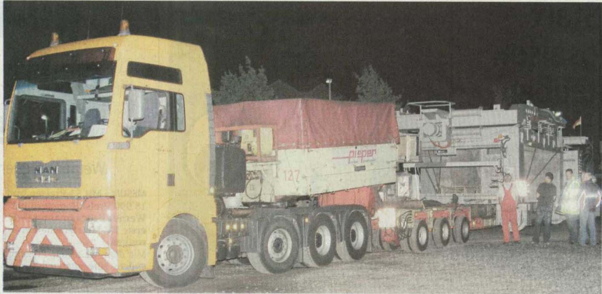
Insgesamt 75 Tonnen bringt der montierte Gießwagen auf die Waage. Mit 6,5 Metern Breite wird die Fahrt ins Saarland an vielen Stellen zu wahrer Millimeterarbeit.
